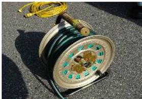
①2P延長コード、漏電遮断器なし
